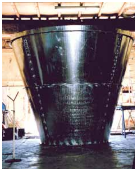
Diffuseur de ventilation pour aération de galerie souterraine
