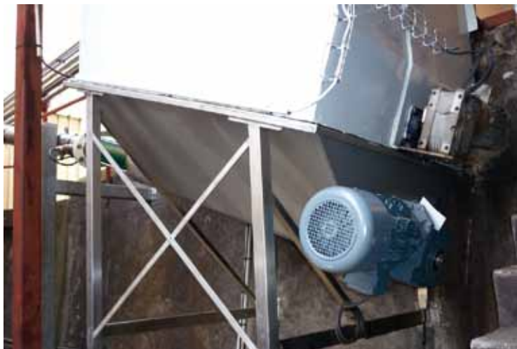
Adaptation conquet de réception de déchets avec vis d'extraction
